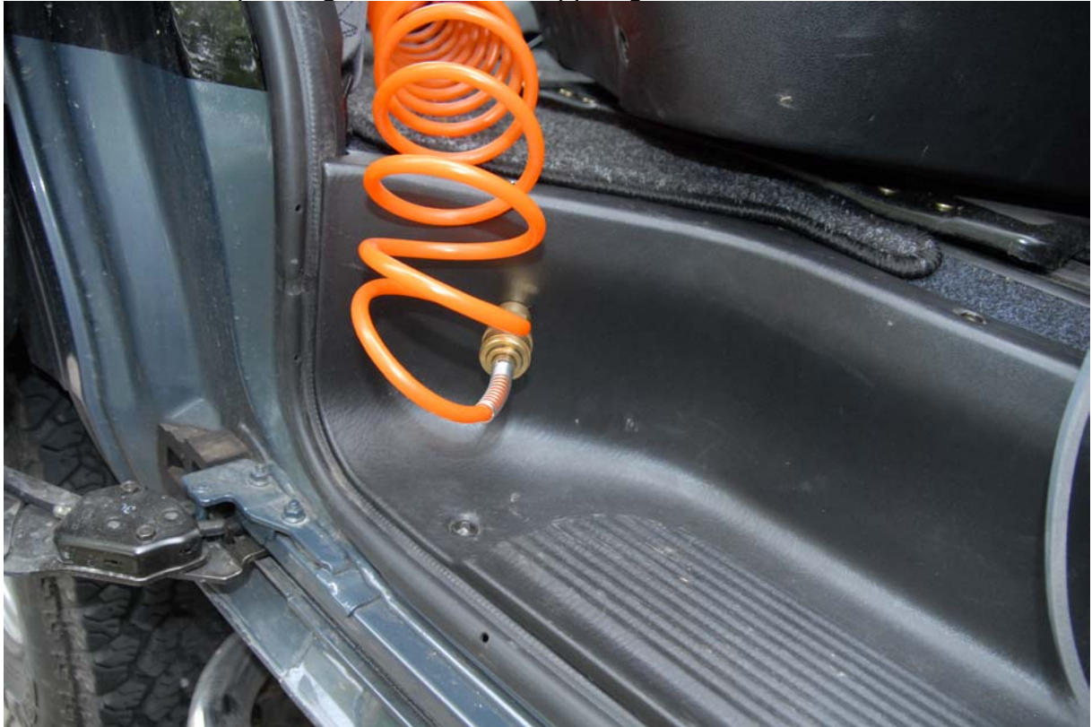
Abb: Druckluftspeisung über Standardkupplungin hinterer Türe
