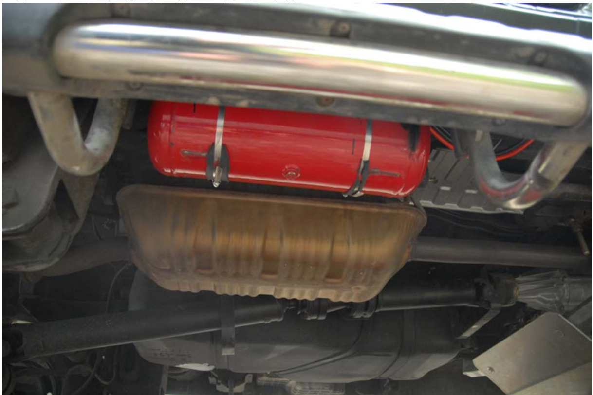
Abb: Blick von unten auf den Druckbehälter
